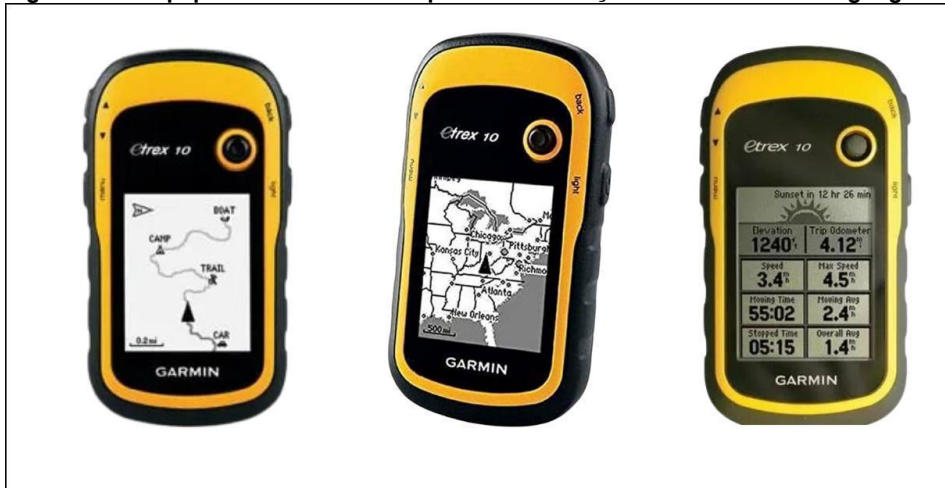
Figura 14 – Equipamentos utilizados para determinação das coordenadas geográficas.
